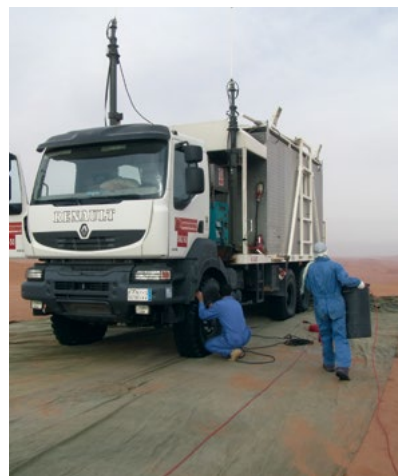
在车底铺设油布，防止车辆滴油污染沙地
